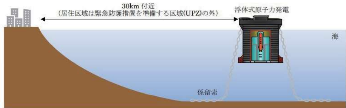
■図表 4. 浮体式原子力発電所
